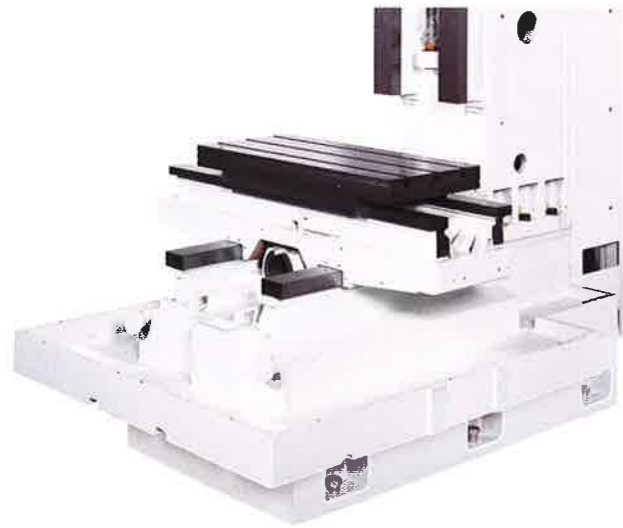
Präzisionsführungen werden nach Hochfrequenz-Härtung geschliffen.
